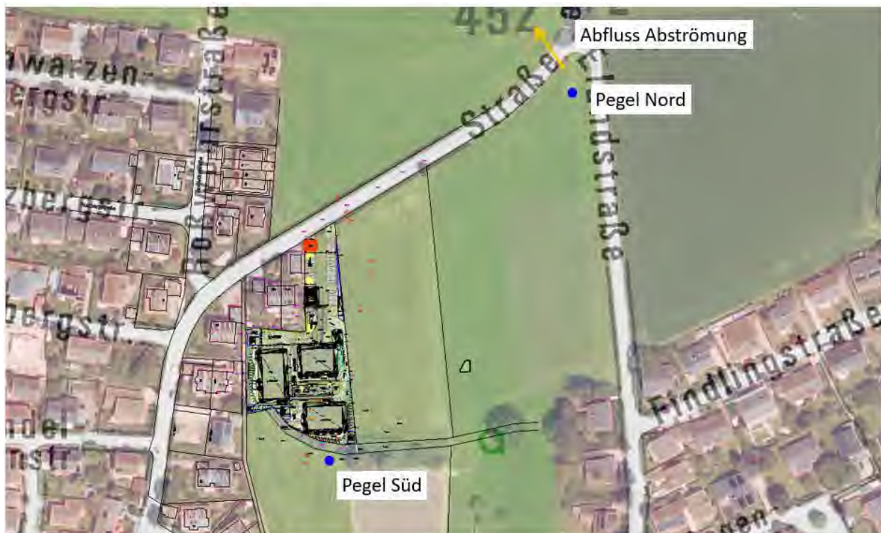
Abbildung 7.15: Auswertestellen, zur Darstellung der Auswirkungen der Planung auf die Abflusssituation (Geobasisdaten: Bayerische Vermessungsverwaltung, 2024)
